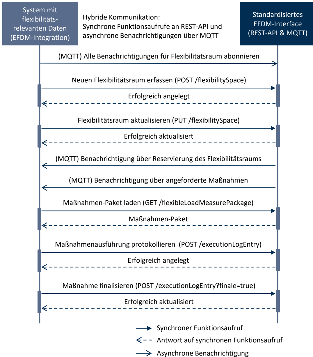
Abb. 8 Standard-Kommunikationsverlauf zwischen Unternehmenssystem und EFDM-Interface
