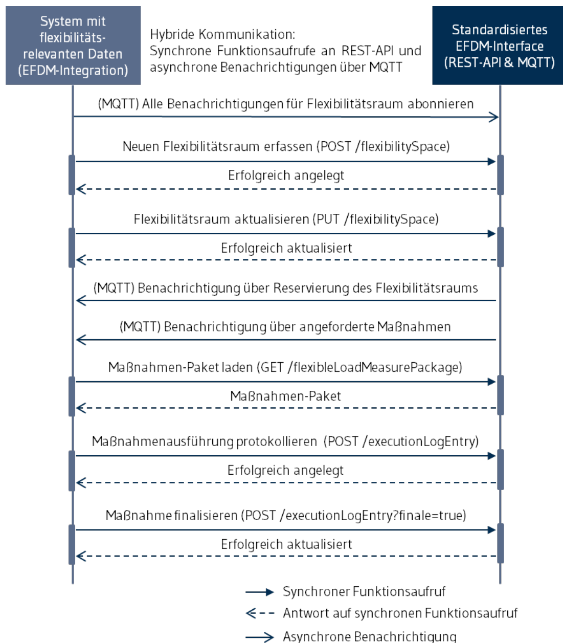
Abbildung 18: Kommunikationsverlauf zwischen Unternehmenssystem und EFDM-Interface
