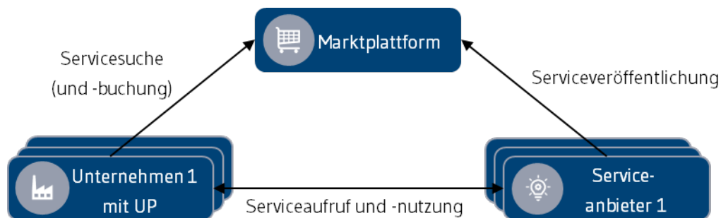
Abbildung 1: Energiesynchronisationsplattform in der Übersicht
